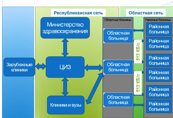
Рис. 10. Структурная схема Национальной телемедицинской сети
