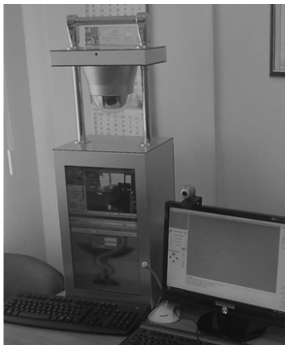
Рис. 1. Отечественный комплекс телемедицинского консультирования КТК-1
