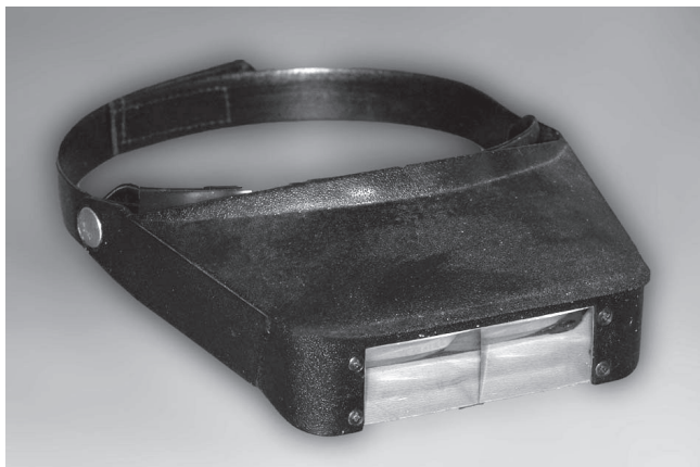
Рис. 1. Бинокулярные лупы: а) козырьковая диоптрическая («flat-plane»); б) лупа конструкции Flip-Up, устроенная по типу телескопа Галилея
